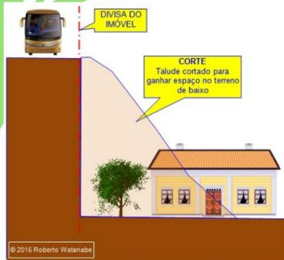
Se o corte ou aterro não for feito de forma adequada, pode provocar a instabilidade da encosta, causando a queda da barreira.
